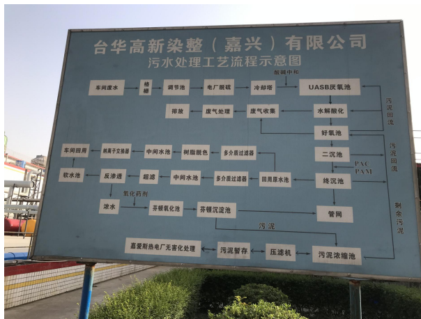
图 4-1 废水处理设施照片
